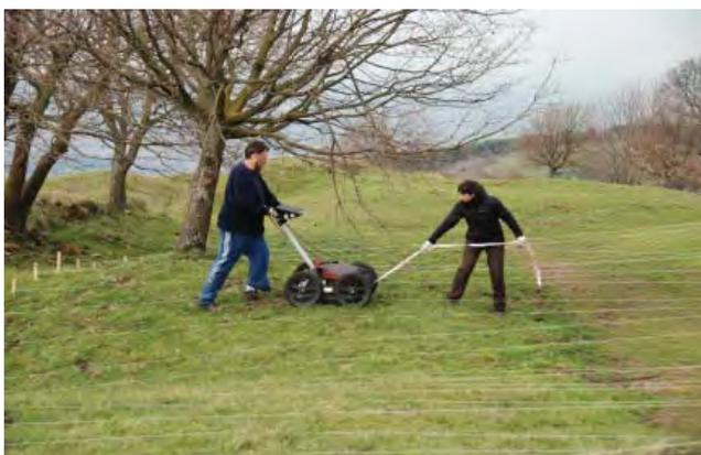
Fig. 3. Foto della fase di prospezione geofisica con georadar (GPR).
