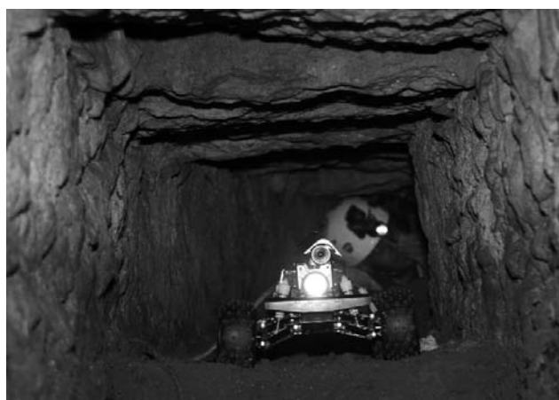
6. Il robot "Tito" all'interno del cunicolo di adduzione idraulica.
